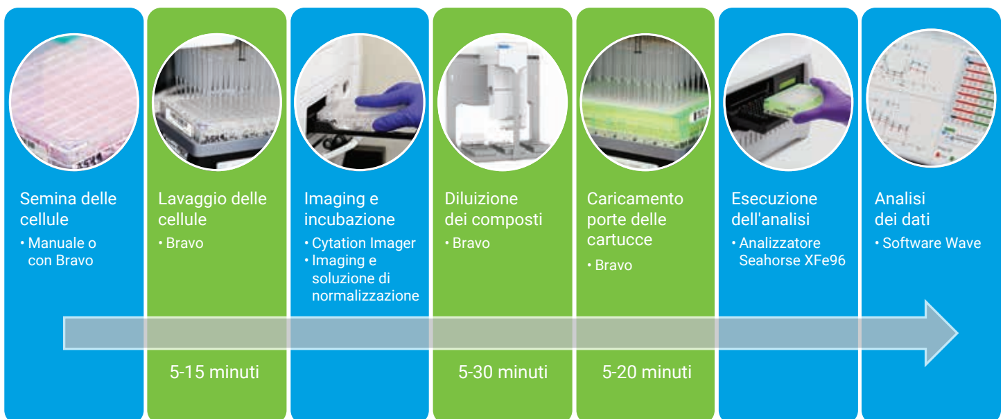
Figura 5. Flusso di lavoro generale per le analisi Seahorse XF. Le fasi di preparazione del campione automatizzate mediante la piattaforma Bravo sono mostrate in verde: lavaggio delle cellule, preparazione delle soluzioni di iniezione e caricamento delle cartucce sensore XFe96. Il risparmio totale sul tempo di manipolazione è di 20-60 minuti per piastra.
